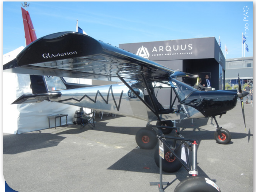
Fabriqué dans les Hautes Alpes, le Styl de G1 Aviation dispose de volets hypersustentateurs qui lui permettent de décoller en 20 m. Il a été choisi par la gendarmerie du Sénégal.
