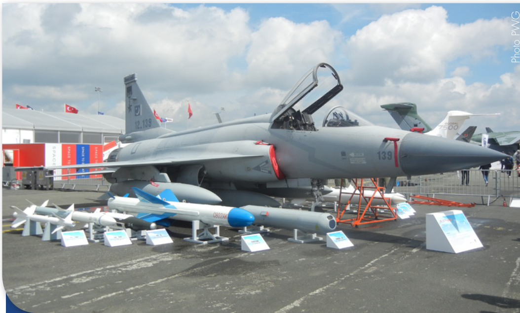
Pour la seconde fois au Bourget, le chasseur pakistanais JF-17, dérivé du MiG-21 et produit en coopération avec la Chine (Chengdu Aircraft Industries). On note l'abondance des armements air-air et air-sol. Le chasseur JF-17 Thunder sino-pakistanais est équipé d'un turboréacteur russe. Il a effectué une démonstration en vol durant le Salon.
